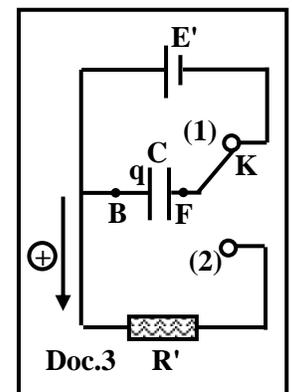
À  $t = 0$ , le commutateur est placé en position 1 ; le condensateur se charge instantanément. Le commutateur bascule alors automatiquement en position 2 et le condensateur se décharge lentement dans (R'). À l'instant  $t_1$  la tension aux bornes du condensateur est  $u_C = u_{BF} = 2,08$  V ; le circuit envoie alors une impulsion électrique au cœur pour obtenir un battement. À ce moment le commutateur passe automatiquement en position 1 et ainsi de suite.
