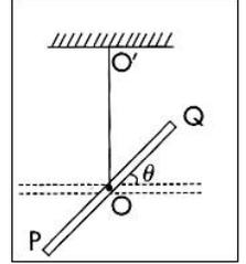
On écarte PQ, dans le plan horizontal, autour de OO' de  $\theta_m = 0,1$  rad à partir de sa position d'équilibre, dans un sens choisi comme sens positif et on l'abandonne sans vitesse initiale à l'instant  $t = 0$ . PQ commence alors à osciller autour de OO', dans le plan horizontal, de part et d'autre de sa position d'équilibre.
